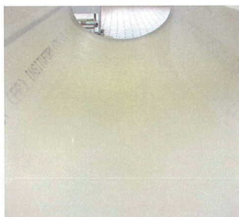
Schéma 4 : surface intérieure du tuyau après 200 000 cycles de charge
